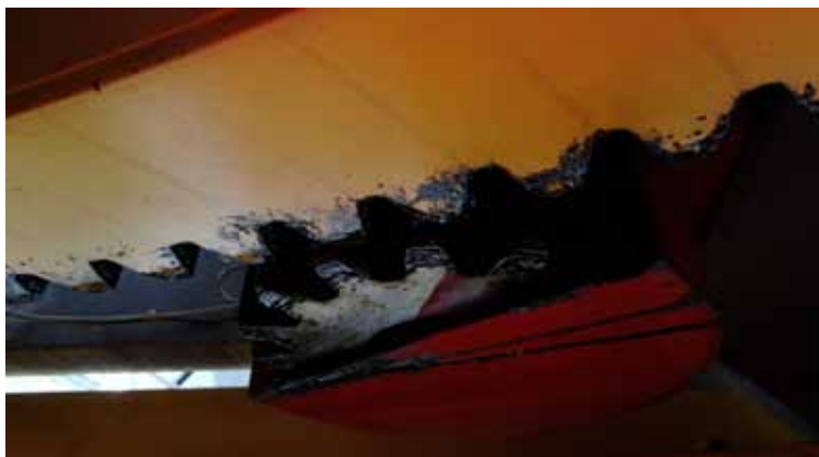
Accoppiamento del pignone di recupero con la corona dentata della puleggia
