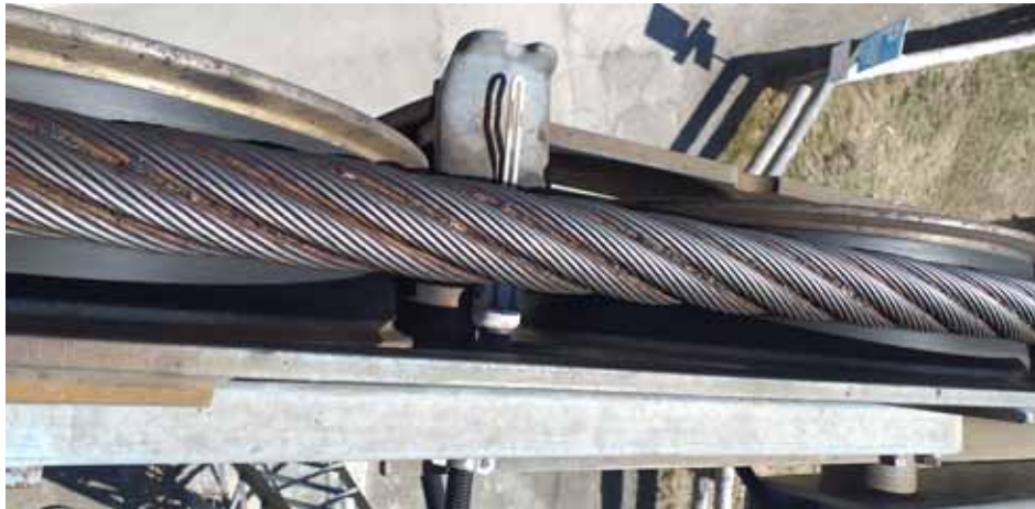
Rulliera e dispositivi di sicurezza anticarrucolamento
