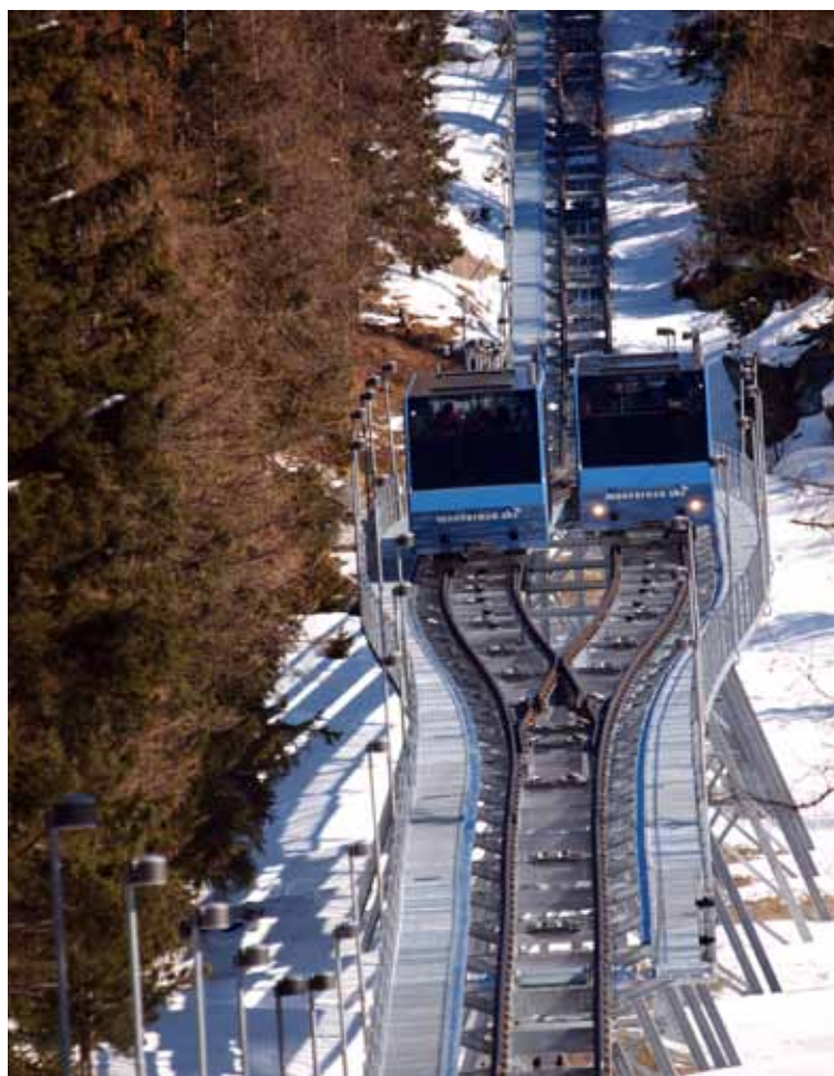
Dettaglio linea funicolare terrestre
