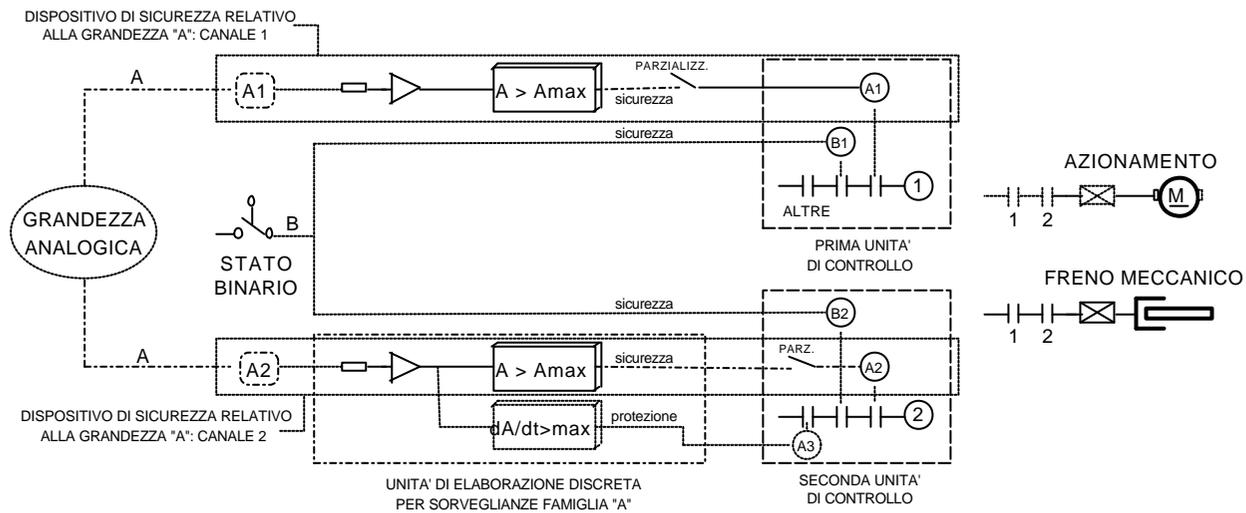
Fig. 3 - SISTEMA CON DUE UNITA' DI CONTROLLO A LOGICA CABLATA
