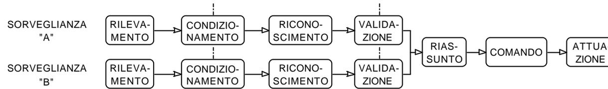
Fig. 2 - ELEMENTI DEL SISTEMA DI SORVEGLIANZA
